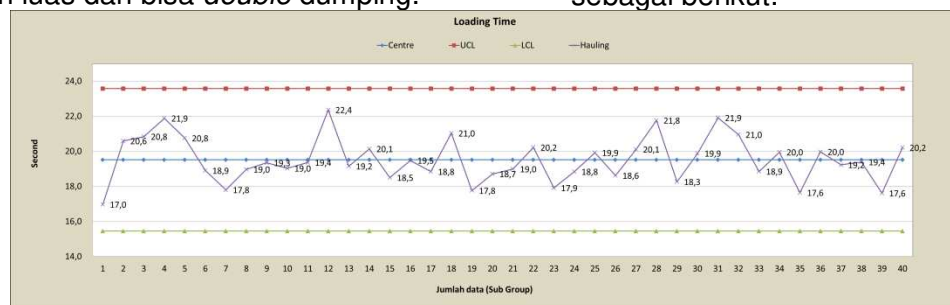
Gambar 6. peta kendali cycle time excavator untuk material waste di zona 3
