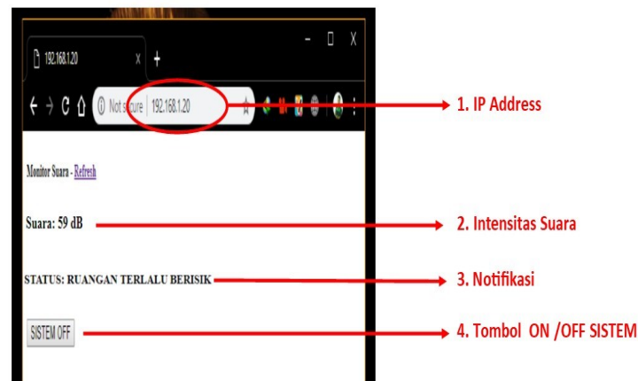
Gambar 13. Contoh Tampilan Kondisi Warning Pada Web Server
