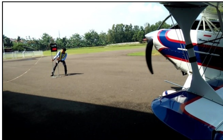
Gambar 16. Pengujian Keseluruhan Alat VDGS Kondisi Engine ON (Baling-Baling Berputar)
