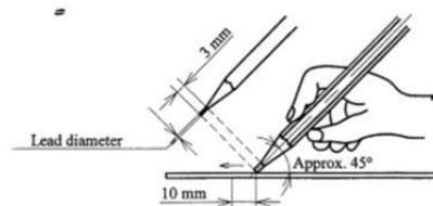
**Gambar 16** Metode pengujian kekerasan lapisan cat
