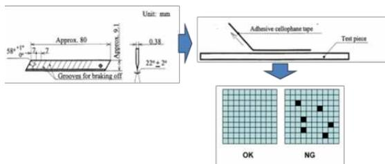
**Gambar 17.** Metode pengujian adhesi
