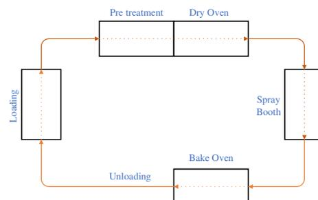
Gambar 11. Flow proses produksi *painting* plastik
