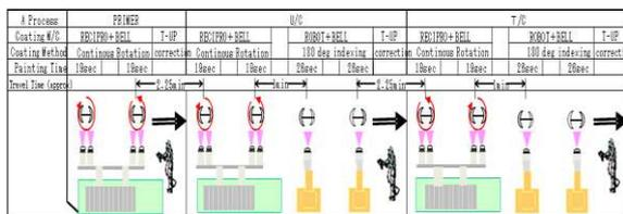
**Gambar 12.** Konfigurasi *Spray booth* untuk proses *electrostatic*
