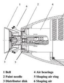
**Gambar 7.** High speed Rotary bell untuk Robot Spray
