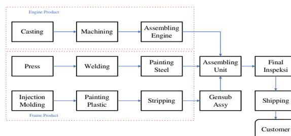
**Gambar 2.** Proses manufaktur di industri perakitan sepeda motor
