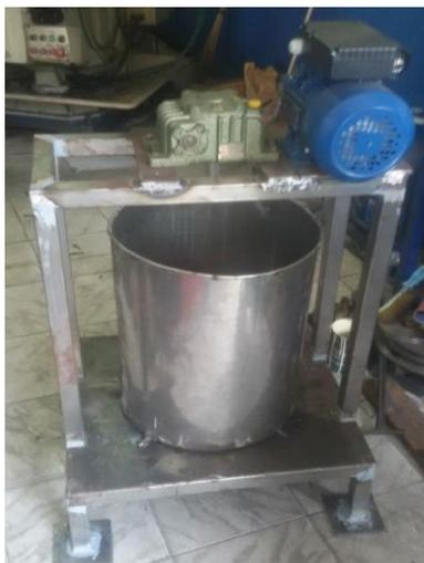
**Gambar 30.** Panci yang terpasang pada rangka
