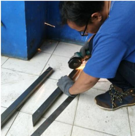
**Gambar 23.** Proses pemotongan material besi pipa kotak
