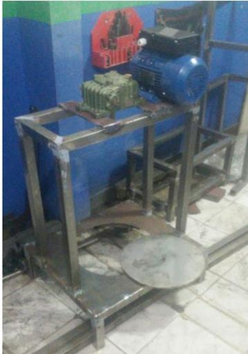
**Gambar 27.** Pemasangan komponen motor listrik
