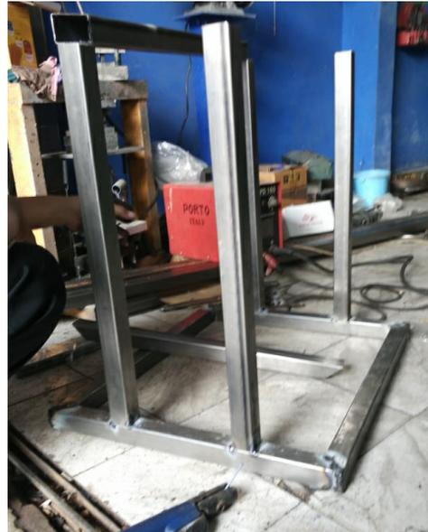
**Gambar 24.** Proses pengelasan rangka
