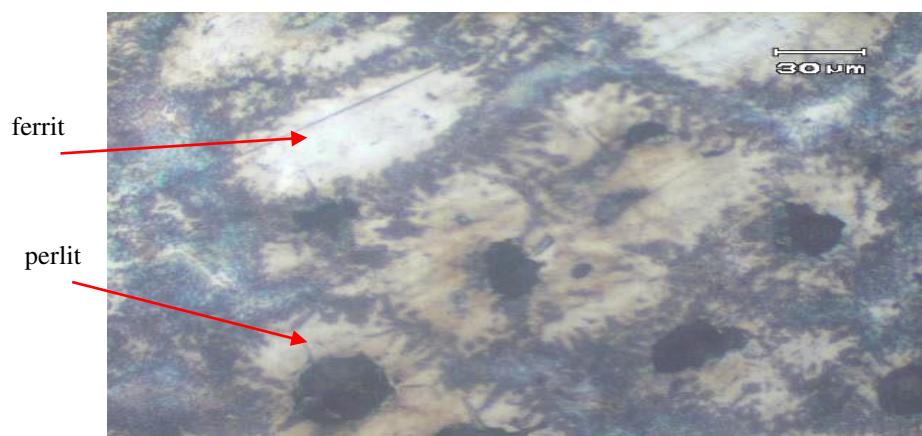
Gambar 2.6 Foto stuktur mikro spesimen 4, fasa perlit dan ferrit, etsa nital 3 %
