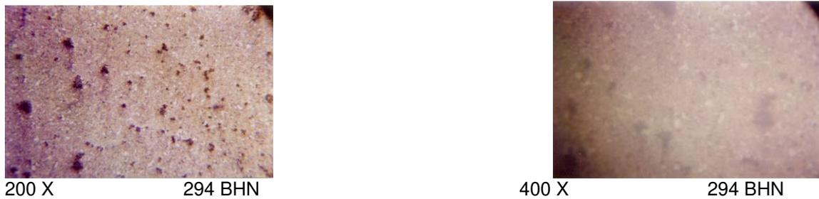
**Gambar 6. Struktur mikro baja St 37 dengan proses karburasi pada temperatur 900oC dengan waktu tahan 2 jam dan proses tempering pada temperatur 150oC, martensit.**
