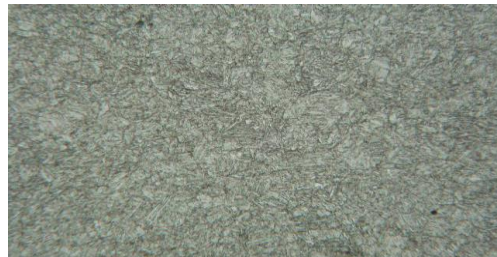
Gambar Foto Struktur Mikro Tanpa Perlakuan Panas, Pembesaran 500X
