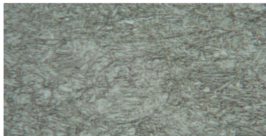
Gambar Foto Struktur Mikro Tanpa Perlakuan Panas, Pembesaran 1000X
