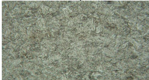
Gambar Foto Struktur Mikro Dengan Hardening 850 °C Pembesaran 500X
