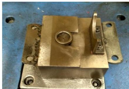
**Gambar 5.** Fixture proses *flange install* sebelum perbaikan.
