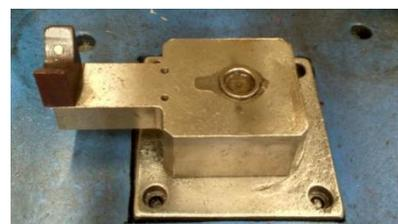
**Gambar 6.** Fixture proses *sleeve install* sebelum perbaikan.
