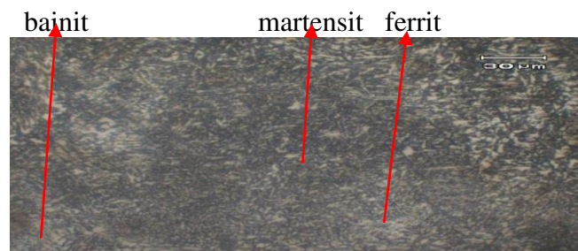
Gambar 6. Struktur Mikro Pada Benda Uji Las GTAW Daerah Logam Lasan
