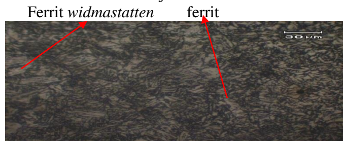
Gambar 10 Struktur Mikro Benda Uji Las SMAW Pada Daerah HAZ B
