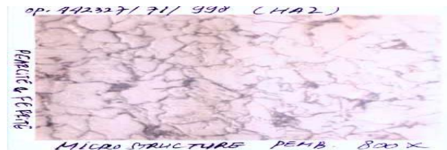
Gambar 10. Struktur Mikro daerah HAZ
