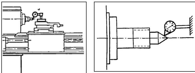
**Gambar 5.** Metode Pengujian Simpang Putar Pada Senter (*Centre point for true running*); (Sumber: Georg Schlesinger, 1970, pp 53)
