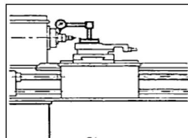
**Gambar 4.** Metode Pengujian simpang putar pada ujung senter sleeve (*Center sleeve for true running*), (Sumber: Georg Schlesinger, 1970, pp 53)
