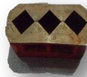
1.b. Cetakan mortar
