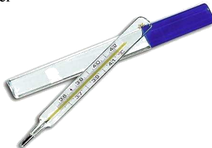
Gambar 1. Termometer air raksa
