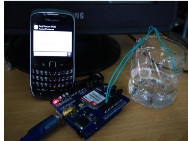
Gambar 9. Uji coba Laboratorium GSM module.
