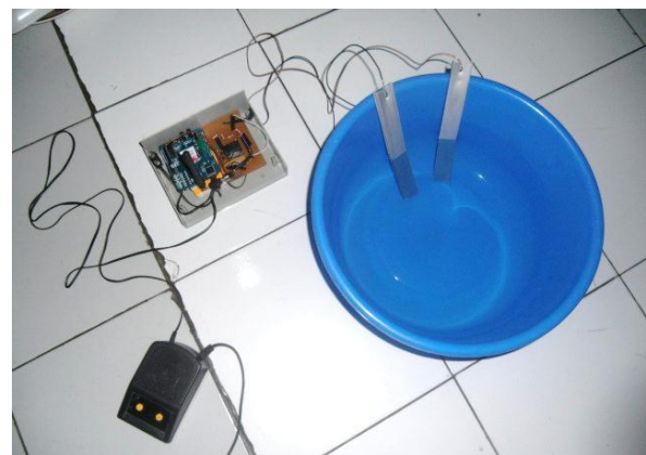
Gambar 10. Uji coba Laboratorium sistem sensor untuk peringatan melalui SMS
