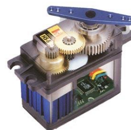
Gambar 7. Susunan komponen motor servo [5].
