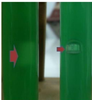
Gambar 4. Sampel minuman hasil uji adanya mikroba dalam media BGLB. Tanda panah menunjukkan adanya gelembung gas dalam tabung Durham
