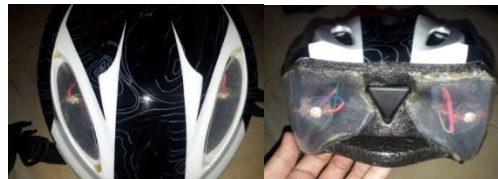
Gambar 3. Penempatan Posisi Lampu Sein Bagian Depan dan Belakang
