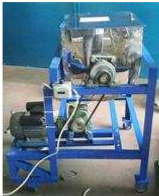
Gambar 3. Pembuatan akhir mesin pengaduk adonan ampiang
