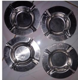
Gambar 3.4 Produk asbak hasil uji coba pembentukan pada cetakan *drawing*
