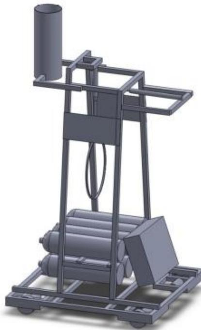
Gambar 3.1. Gambar Rancangan Robot pelontar shuttlecock
