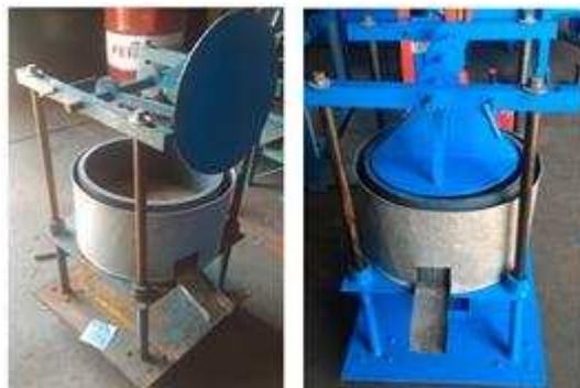
Gambar 5. Mesin sebelum dan sesudah perbaikan
