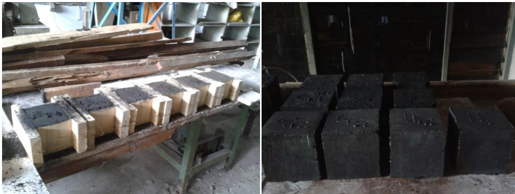
Gambar 4. Batako dari limbah SBE
