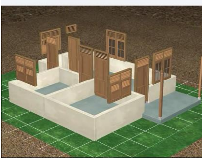
Gambar 8 Tahapan pemasangan konsen
