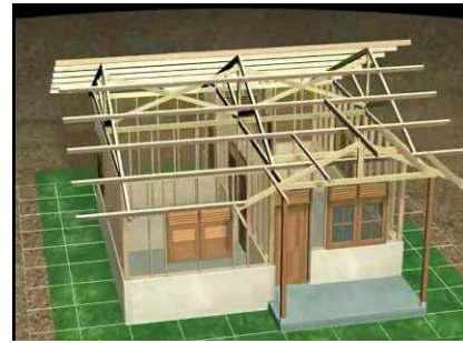
Gambar 11. Tahapan Pemasangan dudukan atap
