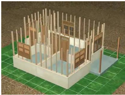
Gambar 9 Tahapan pemasangan tiang
