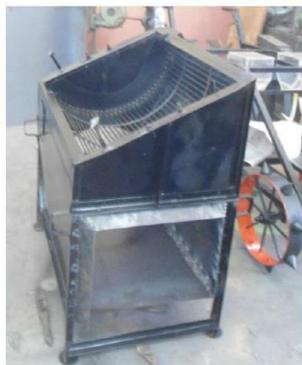
Gambar 8. Lorong Penghembus Pada Mesin Thereser
