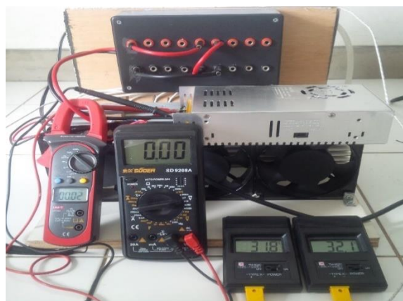
Gambar 5. Pengujian dengan Mengukur Suhu Heatsink ( Step 1 )
