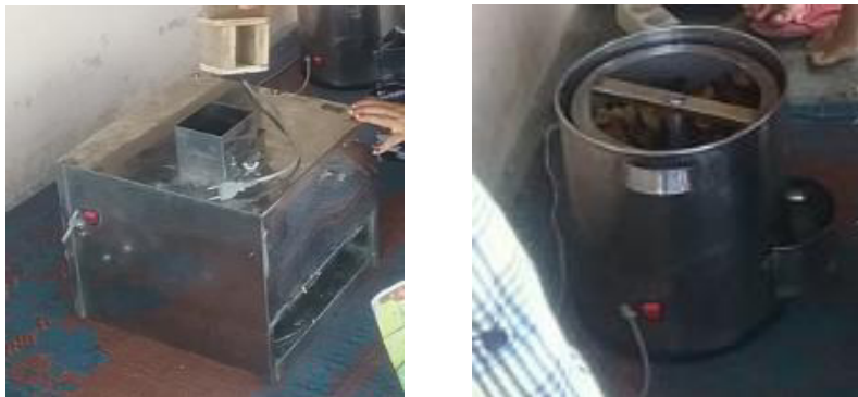
Gambar 2. Peralatan pengiris ubi dan alat peniris minyak
