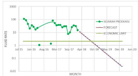
Gambar 13 Peramalan Performa Produksi Minyak Sumur ND-115 Setelah Menggunakan Metode Decline Curve Analysis
