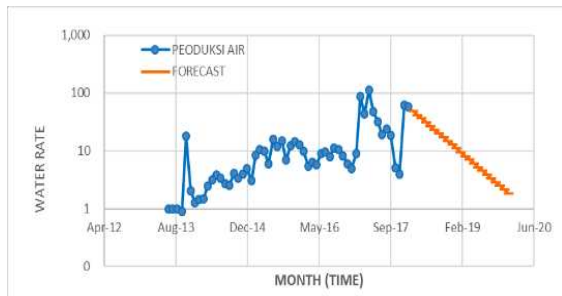
Gambar 15 Peramalan Performa Produksi Air Sumur ND-05 Setelah Menggunakan Metode Decline Curve Analysis
