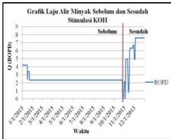
Gambar 3. Grafik Laju Alir Minyak Sebelum dan Sesudah Stimulasi KOH pada Sumur SIB 2
