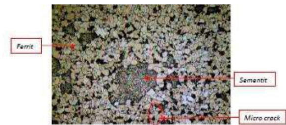
Gambar 5. Pengamatan struktur mikro dilokasi 1
