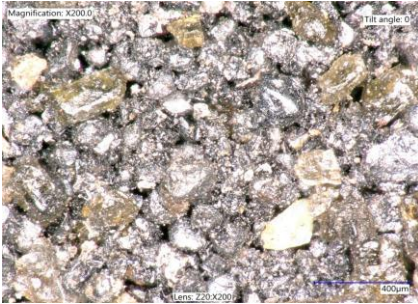
Gambar 4. Ukuran serbuk besi setelah proses dengan waktu 15 menit
