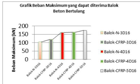
Gambar 8. Grafik beban maksimum yang dapat diterima balok beton bertulang
