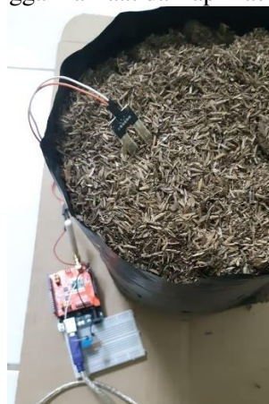
Gambar 11. Pemasangan sensor di media tanam
