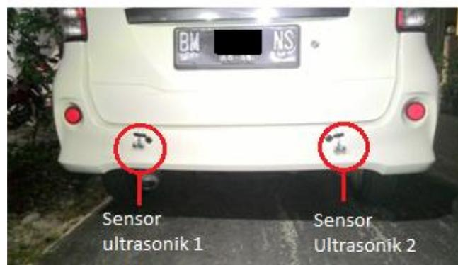
Gambar 10. Sensor Ultrasonik 1 dan 2
