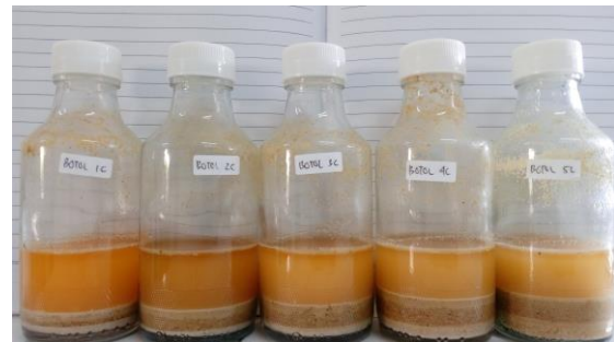
Gambar 2. Sampel adsorben setelah adsorpsi dengan variasi rasio kulit telur ayam dengan sekam padi a) 3:1, b) 2:1, c) 1:1, d) 1:2, e) 1:3.
