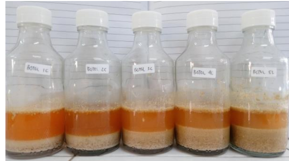
Gambar 1. Sampel adsorben sebelum adsorpsi dengan variasi rasio kulit telur ayam dengan sekam padi a) 3:1, b) 2:1, c) 1:1, d) 1:2, e) 1:3.
