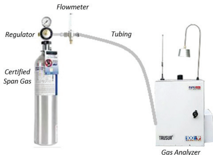
Gambar 1. Ilustrasi kalibrasi gas analyzer dengan perbandingan langsung certified span gas
