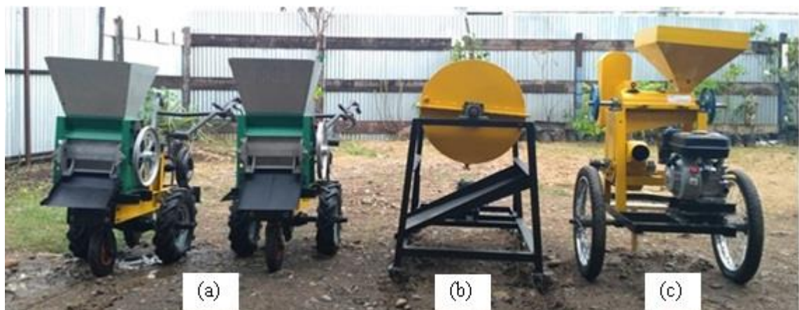
(a) Mesin pengupas kulit kopi berjalan (b) Mesin pencuci biji kopi (c) Mesin pengupas biji kopi (Huller) berjalan
