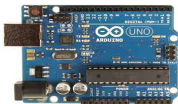
Gambar 1. Arduino Uno Atmega328 (Sumber : http://www.farnell.com/ )
