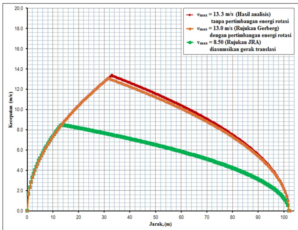
**Gambar 3.** Estimasi kecepatan longsor Booi (warna merah menunjukkan lintasan estimasi kecepatan longsor perhitungan, warna coklat menunjukkan lintasan estimasi kecepatan menggunakan rumusan Gerberg dan warna hijau adalah lintasan estimasi kecepatan menggunakan rumusan Masuya)
