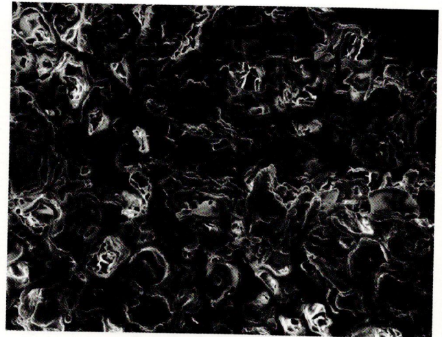
Gambar 3. Gambar SEM struktur kelapa parut kering dengan perbesaran 150X
