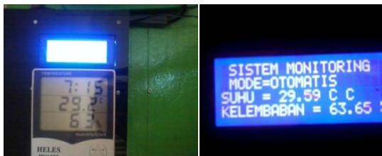
Gambar 7. Membandingkan Pengukuran Sensor
