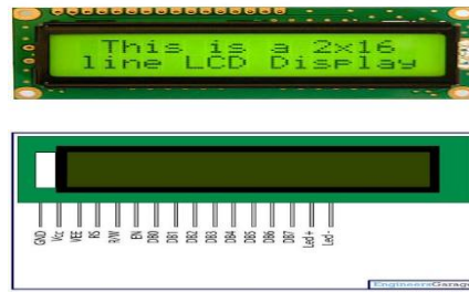
Gambar 2. Bentuk Fisik LCD 16 x 2 dan konfigurasi pinnya
