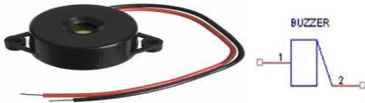
Gambar 4. Bentuk fisik Buzzer Elektronik dan Symbolnya
