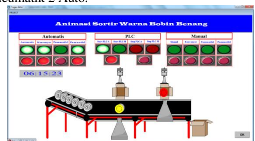
Gambar 42. Proses Awal Sortir Bobbin Merah Secara Auto
