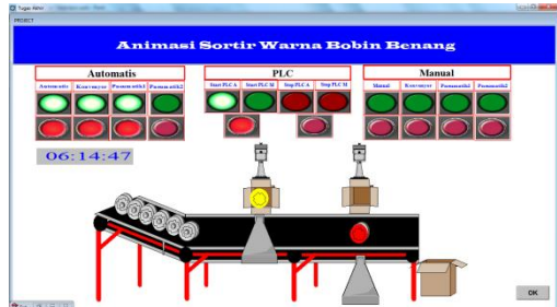
Gambar 41. Proses Sortir Bobbin Kuning Secara Manual
