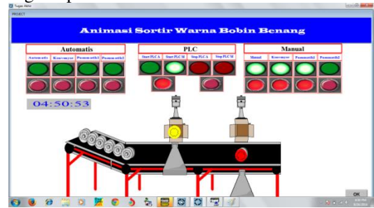
Gambar 36. Proses Sortir Bobbin Kuning Secara Manual
