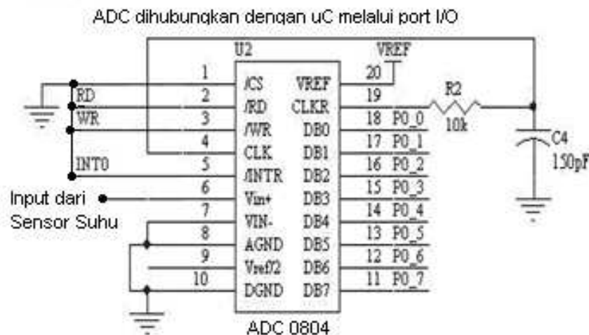
Gambar 3.7. Rangkaian ADC 0804
