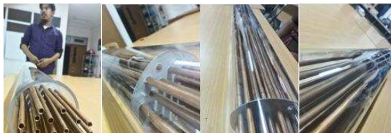
Gambar 10. Shell Dan Tube Pada Purwarupa Heat Exchanger
