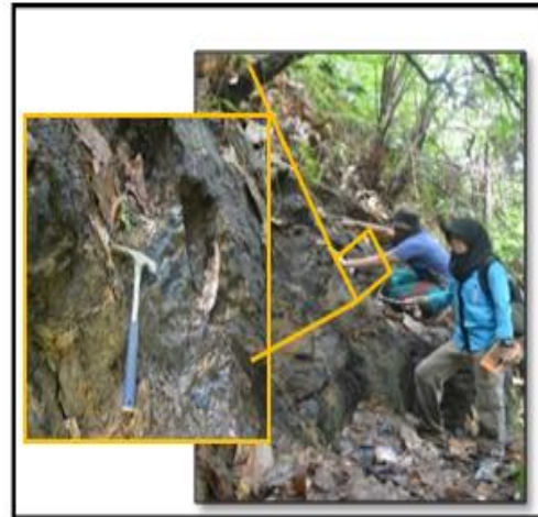
Gambar 4. Kenampakan singkapan mineralisasi kompak galena dan logam ikutan lainnya yang dijumpai pada batuan granit berada di stasiun 07 dan 08. lokasi sebelah timur dari lokasi mineralisasi sungai kalosi (sekitar percabangan dengan S.Pakumbang).
