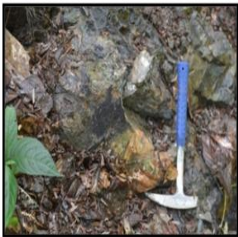
Gambar 6. Kenampakan mineralisasi kompak galena dan ikutannya pada stasiun 11 dijumpai pada batupasir berubah sedang, kompak berwarna abu – abu. Lokasi lereng kiri menuju hulu sungai Peadengeran.
