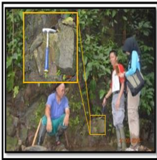
Gambar 2. Kenampakan singkapan galena bentuk menyebar (disseminated) yang dijumpai pada batu pasir kompak, terubah sedang umumnya berwarna hijau dimensi singkapan 5,0 m x 6,0 m, lokasi sungai kalosi (sekitar percabangan dengan S.Pakumbang).
