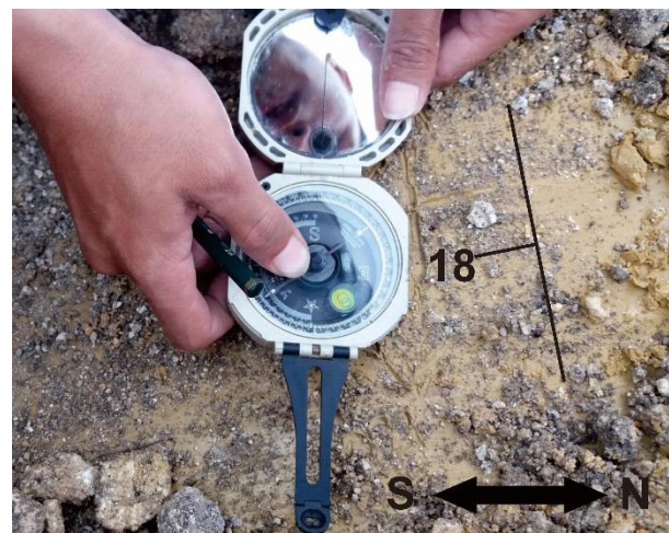
Gambar 4. Bidang Gelincir Longsor di Daerah Penelitian (kiri); Pengukuran Bidang Gelincir (kanan)
