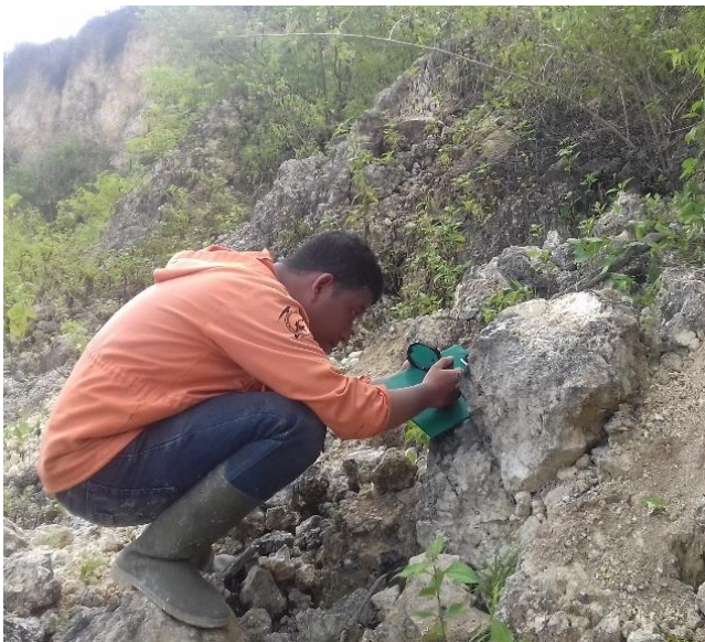
Gambar 3. Pengukuran bidang diskontinuitas (kiri); Orientasi Arah Tegasan daerah Penelitian
