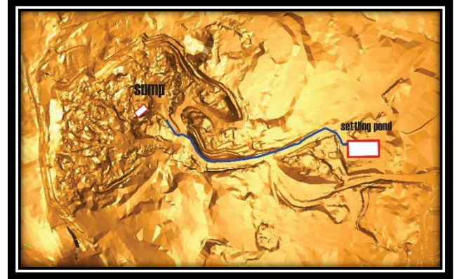
Gambar 2. Gambar Lokasi Sump , Saluran, dan Settling Pond .
