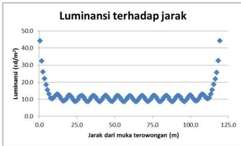
Gambar 9. Hasil simulasi pencahayaan terowongan Tomang siang hari menggunakan tipe lampu LED BVP381 AMB
