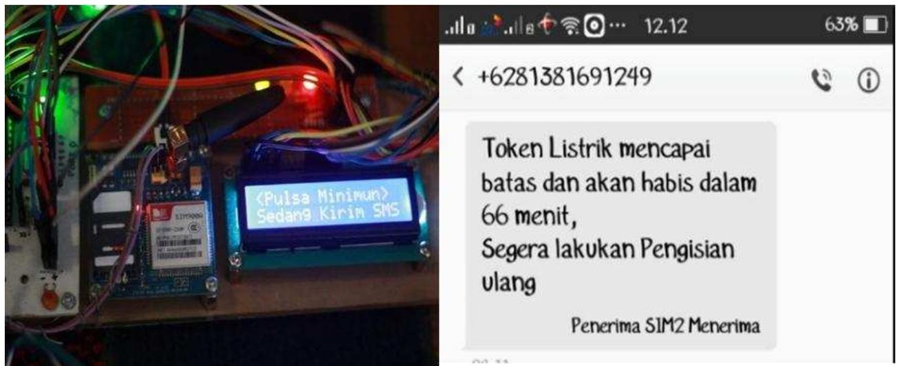
■ **Gambar 13.** Hasil Pendeteksian Alat saat kWh Minimum
